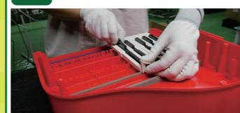
鍵盤の取り付けや部品のネジ留めなど、ミニグランドピアノの組み立て作業を行います。組み立てたミニグランドピアノが、正確な音を出すか確認し、製品として出荷するための検品・梱包作業を行います。
