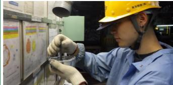
自動車に使用されているパーツの製品が正しく作られているかを確認する、目視検査やゲージ検査を行い、検査結果を品質チェック表に記入します。
