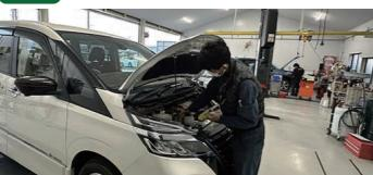
自動車のタイヤの取り付けや空気圧のチェック、ヘッドライトやエンジンルームが正しく動作するかどうかの点検など、自動車が正しく動くかどうかの日常点検を行います。
