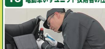
電動車いすユニットのケーブルを通したり、部品の組み立てをしたりして、部品を完成させます。完成した車いすが、正しく走行するか試乗して、確認します。またお客様に合った調整も行います。
